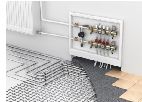
Eksempel på gulvvarme
