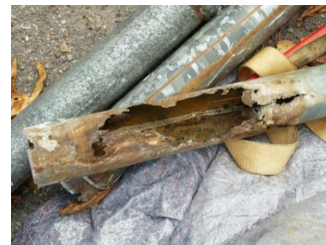
Eksempel på ca. 20 år gammel faldstamme i loro-x Fotoet er ikke fra jeres bygning
